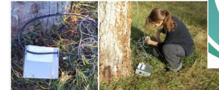
Exemple de enquête: mise en place d'un dispositif d'enregistrement ultrasonore pour une étude sur les chiroptères. © Camille Gazez
